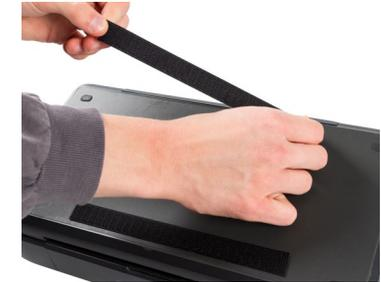
Beiliegend finden Sie das Montageset. Mit Hilfe der Haftstreifen wird der Drucker mittig und bündig zum Papierauswurf im Kofferboden platziert. Durch das Anbringen ist ein rutschfreier Transport garantiert.
